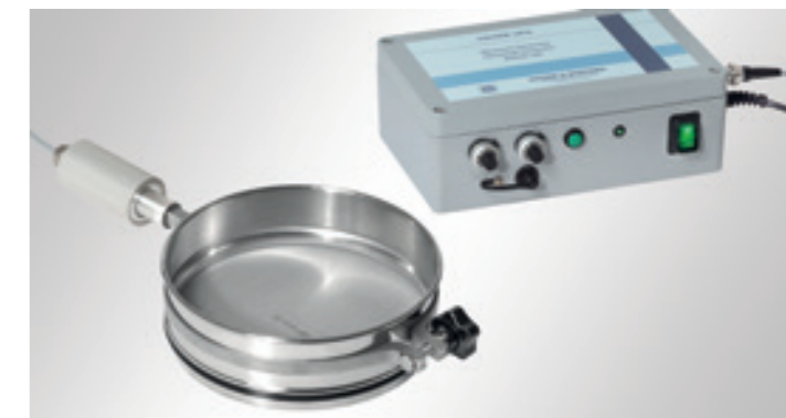
Tamis de contrôle avec anneau de tension, convertisseur et générateur.
